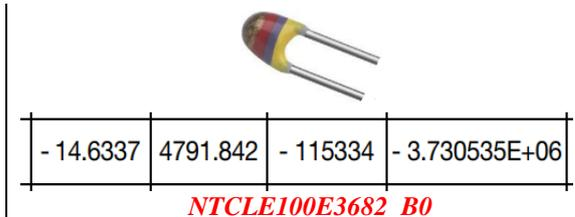
Un paramètre caractérisant une CTN est l'indice de sensibilité thermique, noté  $\beta$  :  $\beta = \frac{T_1 T_2}{T_2 - T_1} \ln\left(\frac{R_1}{R_2}\right)$
