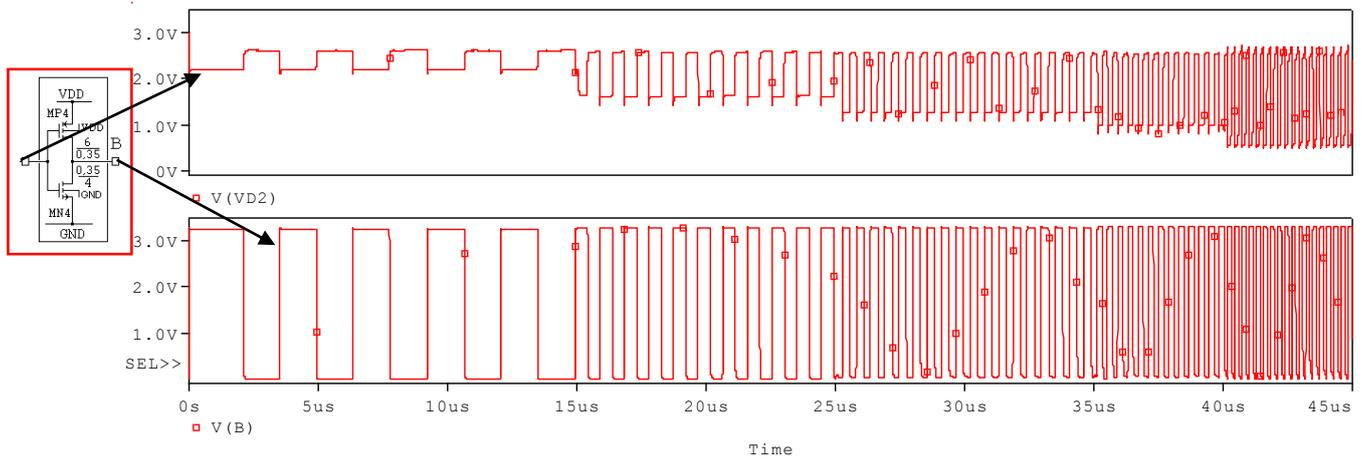
le signal de sortie du CCO est remis en forme logique en V(B)
