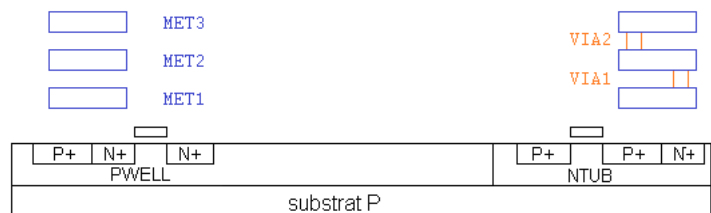
3 niveaux de métallisation dans cet exemple
